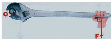
(1-30) شکل د پیچ ټینګول د رنچ په وسیله
